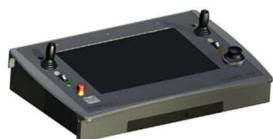
**i-Control GX-1** es la consola más potente de la gama, hasta 4 Playbacks, Space Navigator y gestión integral de cualquier tipo de motores. Hasta 2 pantallas táctiles de 22", una integrada y otra externa.
